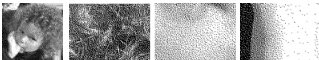
Un rendu FM type crée des grappes de points de taille identique.
